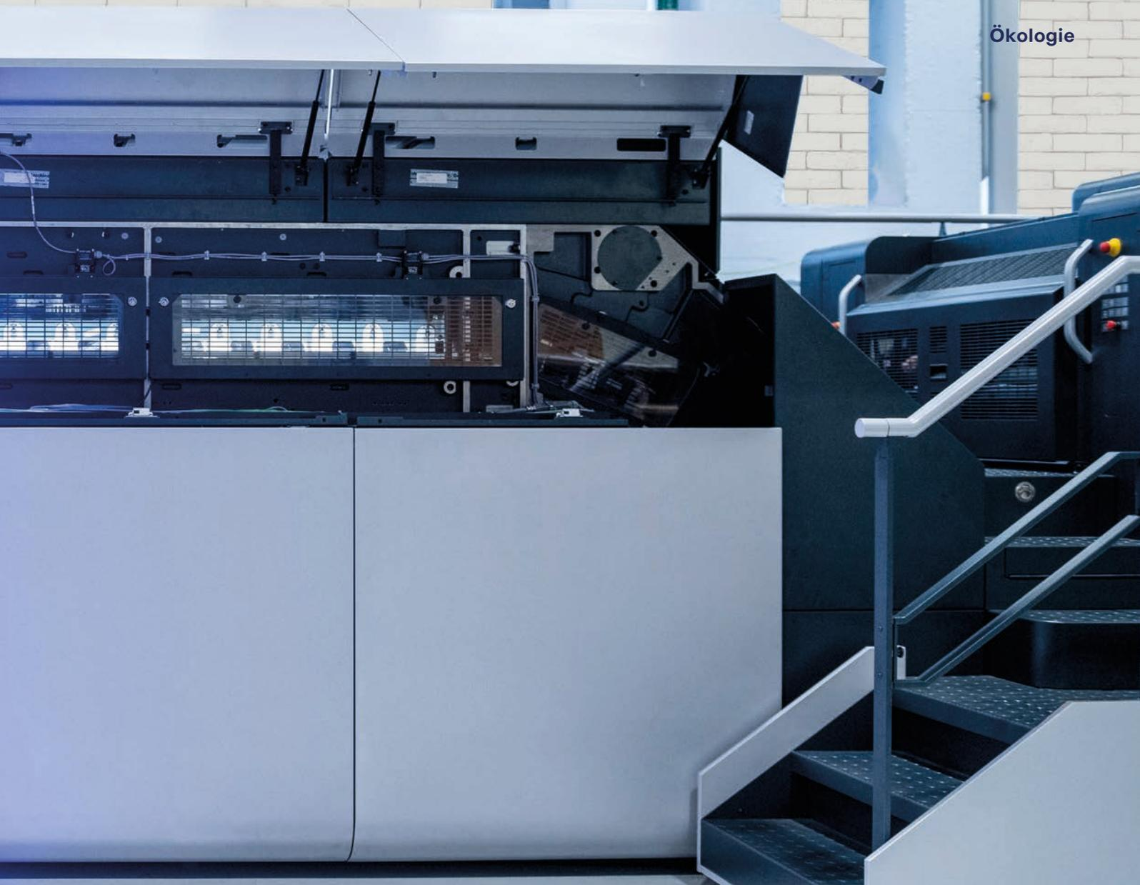
Das beginnt mit der VariDry-Trocknerfamilie: Die **VariDry<sup>Blue</sup>** IR/TL-Trockner in Auslage und Auslageverlängerung verbinden ultimative Trocknungsergebnisse mit geringem Energieverbrauch. Durch die Wiederverwendung der als Trocknungsluft eingesetzten Umluft reduziert sich der Strombedarf im Vergleich zu konventionellen Trocknern in Größenordnungen. Das wirkt sich auf den gesamten Druckprozess aus, denn für die Trocknung wird oft der größte Bedarf an Elektroenergie eingesetzt.
